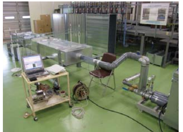
薄板ダクトの性能評価試験状況
