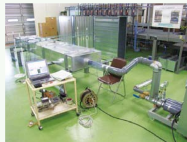
薄板ダクトの性能評価試験状況
