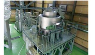
国内最大規模の超臨界CO<sub>2</sub>洗浄再生装置
