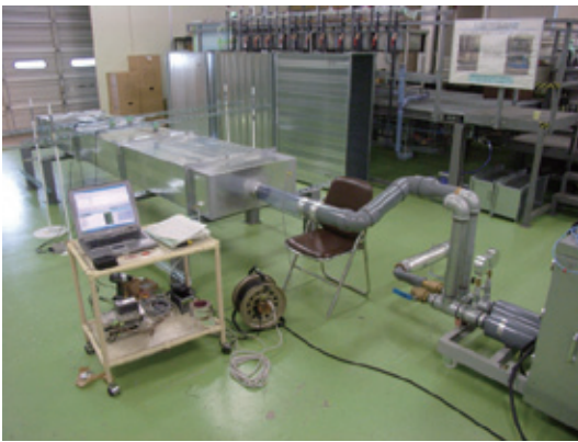
薄板ダクトの性能評価試験状況
