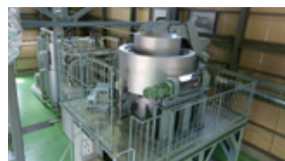
■国内最大規模の超臨界CO 2 洗浄再生装置
