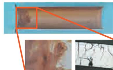
腐食解析一例(配管抜き取り調査)
