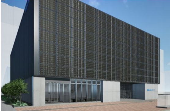
外壁を利用した太陽光発電パネル
